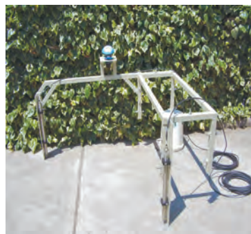
여러 계측기들과 연동 설치된 NivuCompact
